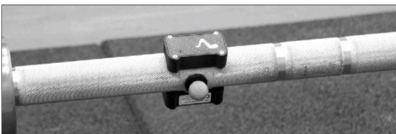
Abbildung 2: Abbildung von zwei Vmaxpro Systemen an der Langhantel mit einem sichtbaren Vicon Marker. Die Vmaxpro Systeme ermitteln intern den Mittelpunkt der Hantelstange und liefern so vergleichbare Ergebnisse untereinander und zu Vicon an dem gewählten Messpunkt.
